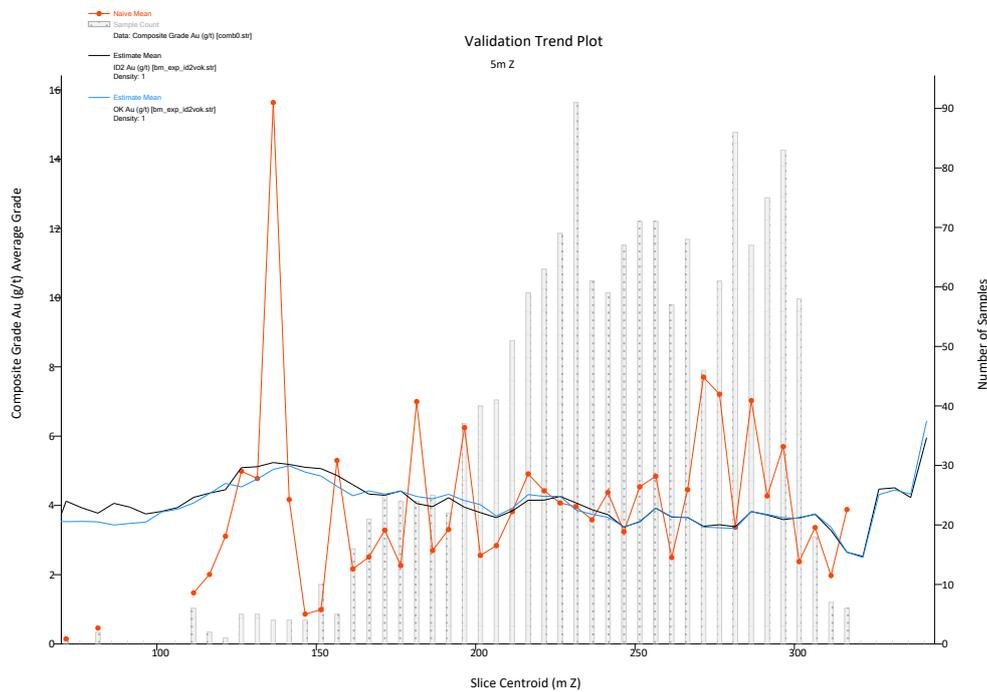
**FIGURE 14-16 ALONG-STRIKE SWATH PLOT COMPOSITE CUT GRADE (ORANGE) VERSUS IDW<sup>2</sup> BLOCK MODEL GRADE (BLACK) VERSUS OK BLOCK MODEL GRADE (BLUE)**
