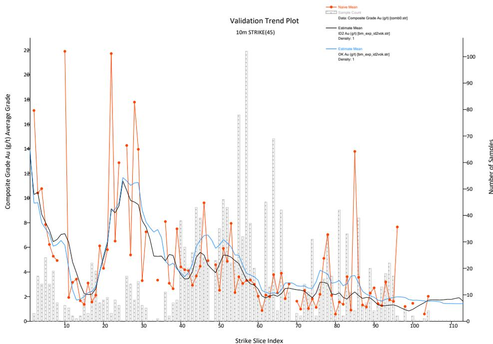
**FIGURE 14-17 CROSS-STRIKE SWATH PLOT COMPOSITE CUT GRADE (ORANGE) VERSUS IDW<sup>2</sup> BLOCK MODEL GRADE (BLACK) VERSUS OK BLOCK MODEL GRADE (BLUE)**
